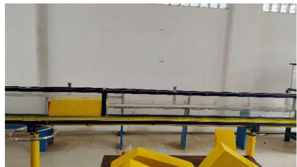
Gambar 2: Replika saluran terbuka
