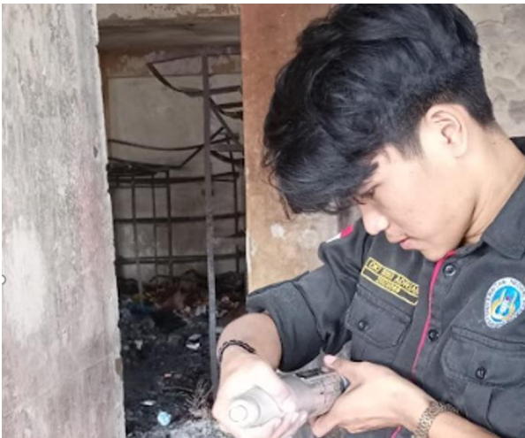
Gambar 6. Pemeriksaan kuat tekan beton kolom menggunakan Hammer test
