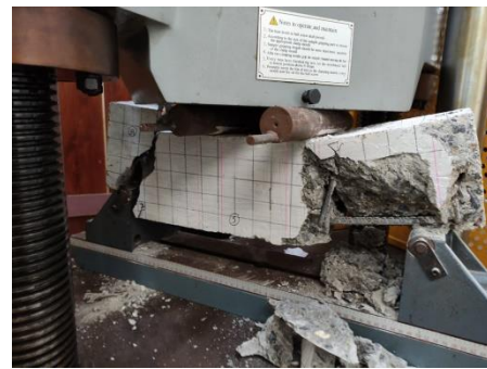
Gambar 3. Patahan Benda Uji
