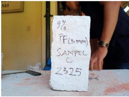
**Gambar 9. Sampel dengan Lapisan Cat Serat Fiberglass 9% setelah Pengujian Kuat Tekan**
