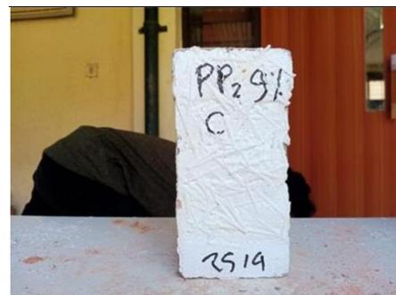
**Gambar 8. Sampel dengan Lapisan Cat Serat Polypropylene 9% setelah Pengujian Kuat Tekan**
