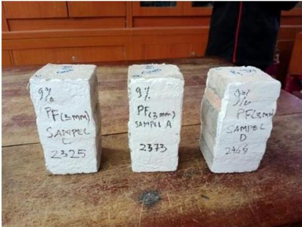
**Gambar 2. Pasangan Bata Merah dengan Lapisan Cat Serat**
