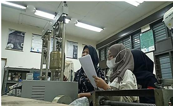
Gambar 3. Uji Penetrasi CBR laboratorium
