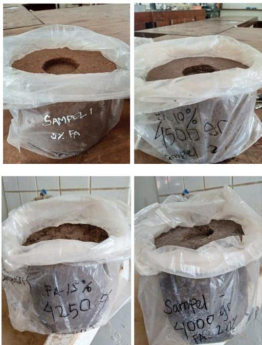
**Gambar 10. Sampel Tanah Campuran *Fly Ash* setelah uji CBR**
