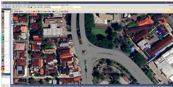
Gambar 15. Pembuatan jaringan berdasarkan data Geometrik simpang
