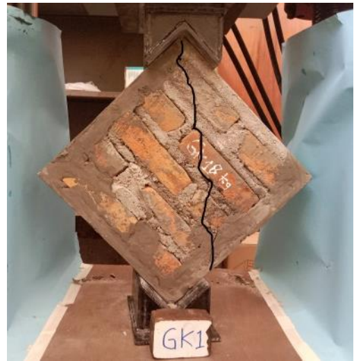
Gambar 12. Pola keretakan dinding kontrol akibat kuat geser
