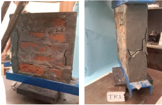
Gambar 10. Pola keretakan dinding kontrol akibat kuat tekan
