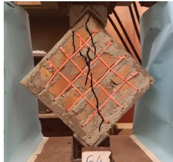
Gambar 13. Pola keretakan dinding perkuatan akibat kuat geser
