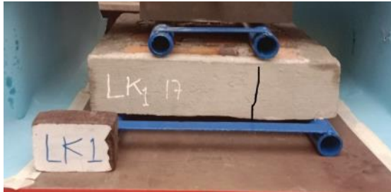
Gambar 14. Pola keretakan dinding kontrol akibat kuat lentur
