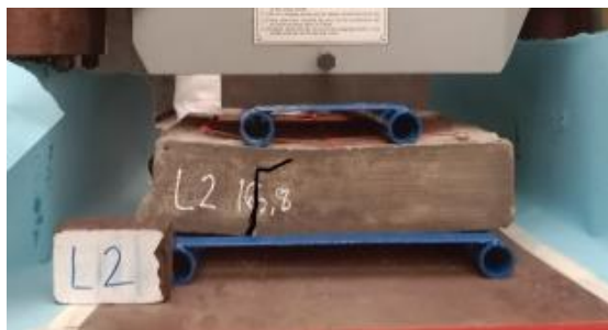
Gambar 15. Pola keretakan dinding perkuatan akibat kuat lentur
