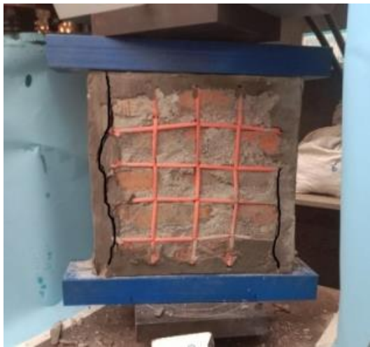
Gambar 11. Pola keretakan dinding perkuatan akibat kuat tekan
