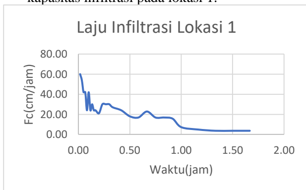
Gambar 3. Kurva Laju Infiltrasi Lokasi 1
