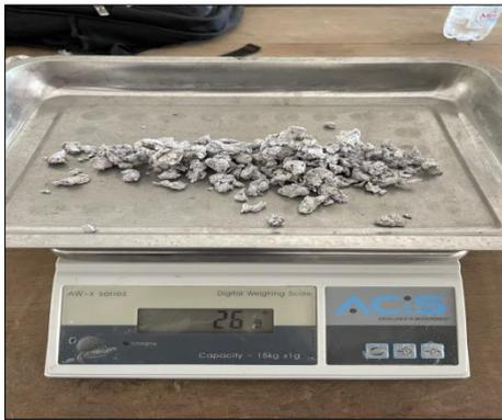
Gambar 2. Pengujian Kadar Air Bubur Kertas
