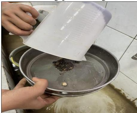
Gambar 5. Pengujian Kadar Lumpur Pasir
