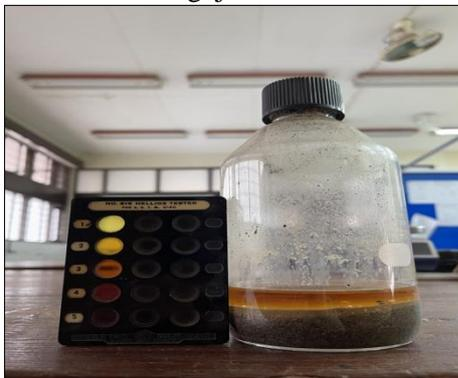
Gambar 4. Pengujian Zat Organik Pasir
