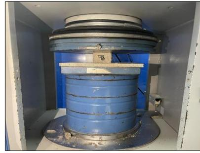
Gambar 9. Pengujian Kuat Tekan Mortar
