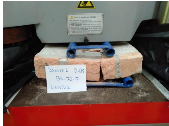
Gambar 4. Pola Kerusakan Pasangan Bata Merah
