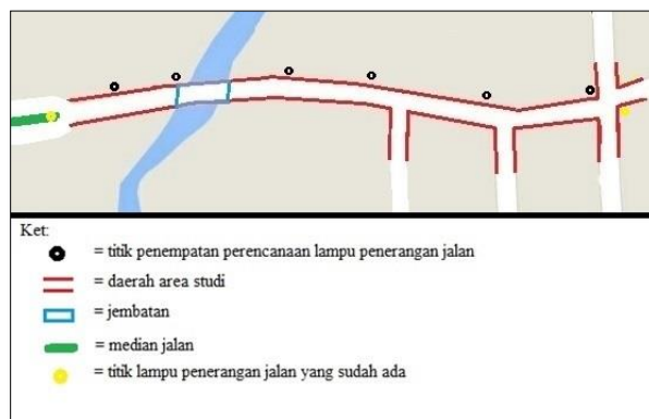
Gambar 4. Ilustrasi Penempatan Lampu Penerangan Jalan
