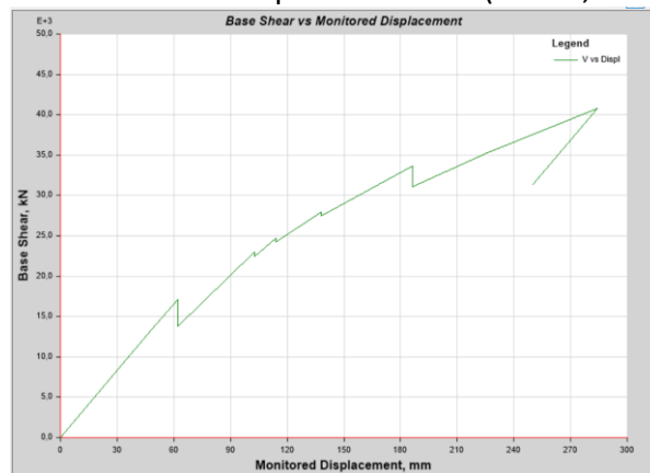
Gambar 2. Kurva Kapasitas Arah Y (ETABS, 2026)
